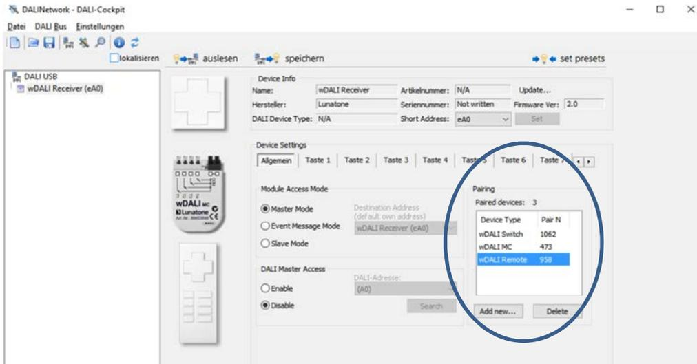
Die Pairingnummer des Bediengeräts ist dem runden Aufkleber auf der Rückseite des Bediengeräts zu entnehmen, Beispiel Switch:
