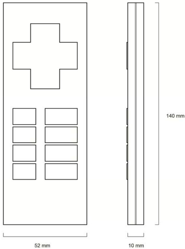
Geometrie Fernbedienung (Bedieneinheit)
