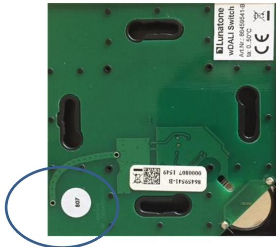
Die im Cockpit aktive Taste wird zwecks Zuordnung bei allen geairten Gerätetypen entsprechend markiert:
