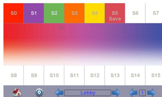
Ein weiteres Feature ist die Unterstützung von DALI DT8 RGB-Leuchten. Das Display ermöglicht das Speichern von RGB-Werten für Szenen. Um vor dem Abspeichern die Stimmung verifizieren zu können wird die ausgewählte Farbe an der aktuell ausgewählte Leuchtengruppe in Echtzeit mitverstellt. Somit lassen sich über die Szenen auch verschiedene Farbstimmungen realisieren.
