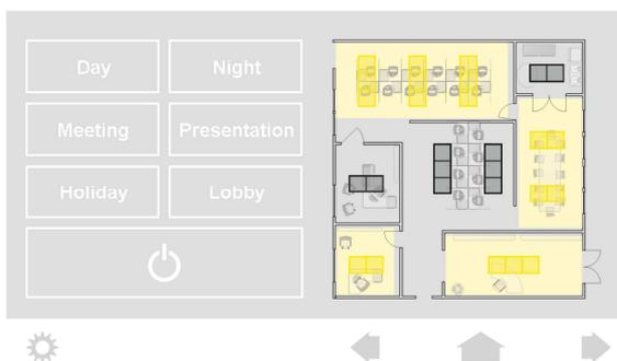
*Custom2: Raumübersichtsplan eines Stockwerks, es können verschiedene Szenen aufgerufen werden. Am Plan ist der aktuelle Beleuchtungszustand in den einzelnen Räumen visualisiert. Die Beleuchtung eines Raums lässt sich auch über direkte Betätigung in der Raumübersicht steuern.*
