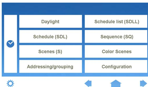
Die für das Display relevanten Einstellungen sind über das Menü „Configuration“ aufrufbar. Dort lassen sich zum Beispiel Sprache und Design auswählen als auch die Hintergrundbeleuchtung, Anzeigoptionen und Netzwerkeinstellungen konfigurieren. Ein für die Anwendung wichtiges Feature ist die Namensgebung für Szenen, Gruppen und Sequenzen. So kann die Darstellung dem Einsatzgebiet entsprechend angepasst werden.
