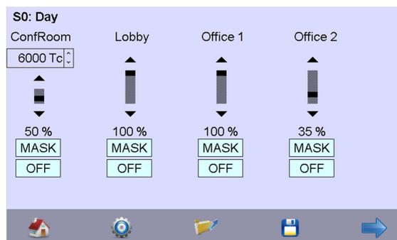
Nachdem die Konfiguration abgeschlossen ist lassen sich über vordefinierte Seiten Gruppen steuern und Szenen aufrufen. Es besteht die Möglichkeit jede dieser vordefinierten Seiten in den Einstellungen zu deaktivieren.
