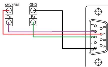
Konfektion Verbindungskabel RJ45 -> SubD (zum Anschluss an RS232 eines PCs, Versorgung über RTS):
