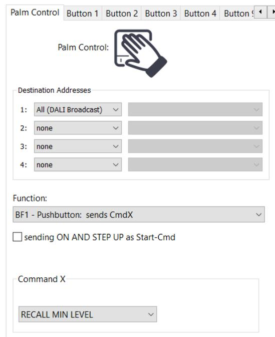
Die Handflächensteuerung ermöglicht schnelle Lichtsteuerung indem die gesamte handfläche auf das Touchpanel gelegt wird.
