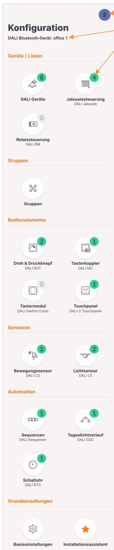
Bluetooth Verbindung wählen – hier ist ein Wechseln zu anderen Bluetooth Room Controllern möglich
