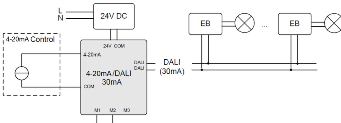
Typ. Anwendung Dali Steuerung mit 4-20mA Eingang
